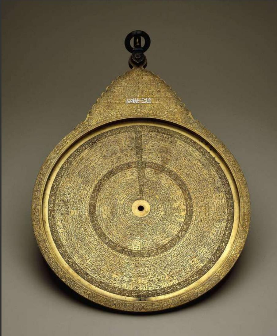
*Un astrolabio è uno strumento che permette di misurare l'altezza delle Stelle, della Luna o del Sole sull'orizzonte e di determinare relazioni di carattere astronomico e topografico, senza ricorrere a calcoli o formule matematiche. (Treccani)*
