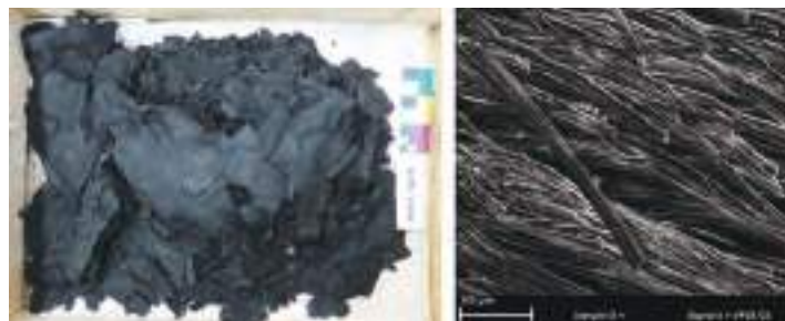
Fig. 13. Alcuni dei numerosi e sottili frammenti tessili carbonizzati (Pompei, 18061B, tipo 17). Sulla destra micrografia con microscopio elettronico a scansione delle fibre di Linum usitatissimum L. di cui è composto il tessuto (Foto F. Coletti).
