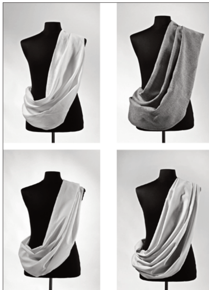
Fig. 7. Esperimento sulla qualità. In alto sono messe a confronto due stoffe di lino di qualità fine (sinistra) e grossolana (destra); in basso due stoffe di lana di qualità fine (sinistra) e grossolana (destra). Esperimento, concezione e realizzazione: A. Paetz gen. Schieck, S. Mitschke (Foto Jean Christen, rem/CEZA).
