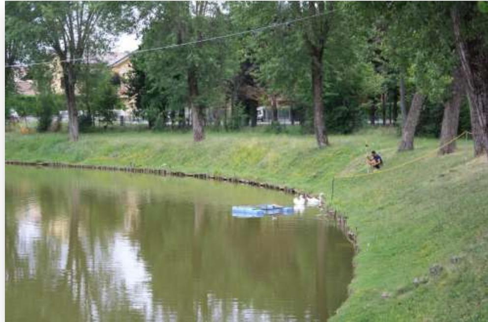
Il rilievo del lago è stato eseguito per semina di punti con il GPS Leica 1230, aggiungendo all'altezza dell'antenna di ogni singolo punto la profondità dell'acqua data dall'ecoscandaglio.
